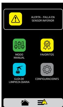
c) Siga la orientación conforme descrito en la pantalla en este caso, apague y encienda nuevamente el horno utilizando el botón del panel:
