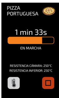
e) Es posible verificar la temperatura de la Resistencia de la Cámara y de la Resistencia Inferior presionando el botón
