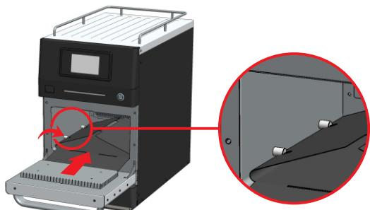
2- FALTEN SIE DIE KLAPPEN ZUSAMMEN UND SETZEN SIE DEN EASY CLEAN LINER IN DAS GERÄT UND DANN IN DIE SEITLICHEN FÜHRUNGEN EIN, WIE ABGEBILDET.
